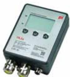
**Basisgerät für IY.Ex-Sensoren.** Universal Messumformer zur Montage in Zone 1/2/21/22; Umgebungstemperatur -40...+70°C; IP66; Temperaturklasse T4 für alle Gase und Stäube; vor Ort parametrierbar; Display, Edelstahl/Polymer Compound-Material für höchste Korrosionsbeständigkeit; 0...10V oder 4...20mA Rückmeldung; keine weitere Barriere im Schaltschrank erforderlich; LED-Statusanzeige; einfache Montage; 24 VAC/DC
