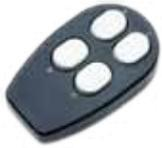
Zum mobilen Schalten und Dimmen von Beleuchtung, oder um Rollläden und Jalousie auf- und abzufahren und die Lamellen zu verstellen. Bei der 2-Tastenbedienung gehören das Tastenpaar A/B und C/D zusammen. Die Energieversorgung des Gerätes erfolgt über elektrodynamische Energiewandler bei der Tastenbetätigung.
