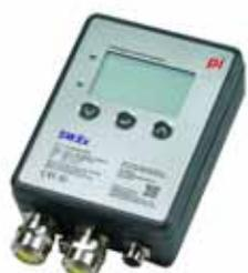
**Basisgerät für IR.Ex-Sensoren.** Universal-Ex-Schaltverstärker zur Montage in Zone1/2/21/22, zwei parametrierbare Schaltpunkte / Relaisausgänge; Umgebungstemperatur -40...+70°C; IP66; Temperaturklasse T4 für alle Gase und Stäube; einstellbare Hysterese; vor Ort parametrierbar; Display, Edelstahl/Polymer CompoundMaterial für höchste Korrosionsbeständigkeit; keine weitere Barriere im Schaltschrank erforderlich; LED-Statusanzeige; einfache Montage; 24 VAC/DC
