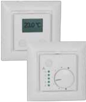
Raumtemperaturfühler-/Regler zur Messung der Temperatur, mit oder ohne Display sowie Sollwertgeber über den KNX Bus oder über die Gerätefunktion. PI-Regelung für die Ansteuerung von EIB-Regelventilen.
