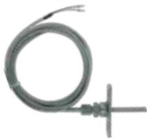
Hochtemperatur Kabelfühler mit passivem oder aktivem Fühlersignal, geeignet zur Messung von Rauchgastemperatur von Heizkesseln und ähnlichen Anwendungen im Bereich von hohen Temperaturen. Inkl. Montagevorrichtung. Temperaturbereich 0...400°C. **(Temperatur-Bereiche programmierbar ab Werk)**
