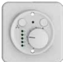
Raumbediengerät mit Sollwertgeber, Präsenztaste, LED sowie Stufenschalter analog A-0-1-2-3 (0...2V). Der Sollwertgeber ist mit passiven oder aktiven Ausgangssignal verfügbar.
