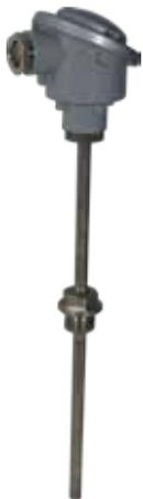
Rauchgasfühler mit Halsrohr mit passivem oder aktivem Fühlersignal, geeignet zur Messung von Rauchgastemperatur von Heizkesseln und ähnlichen Anwendungen im Bereich von hohen Temperaturen. Anschlusskopf Form DIN B in IP65 Ausführung. Temperaturbereich 0...400°C. **(Temperatur-Bereiche programmierbar ab Werk)**
