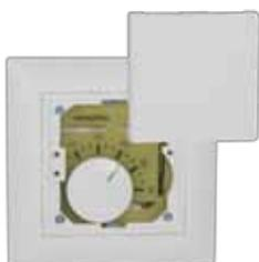
Bimetall Raumthermostat Unterputz Typ Feller 4250 mit Sollwert-Innenverstellung. Die Anpassung des Sollwertes erfolgt unter dem abnehmbaren Deckel. 230VAC oder 24VAC/DC (DC max. 30W)
